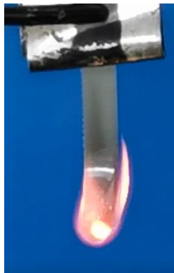
Figure 2: Combustion d'un échantillon de PHB
